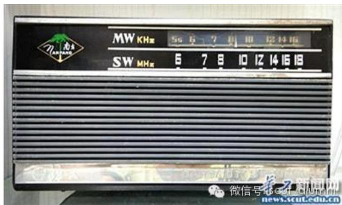
1973年，广州南方无线电厂研制并批量生产的南方牌6J1、7J2型二波段超外差式晶体管收音机，灵敏度高、音质好、外形美观，并满足了边远山区由于用中波接收困难，需用短波收听节目的要求。7J2型二波段超外差式晶体管收音机生产时间长、批量大，是收音机市场的畅销品。在1973~1981年期间，累计生产48.08万台。
