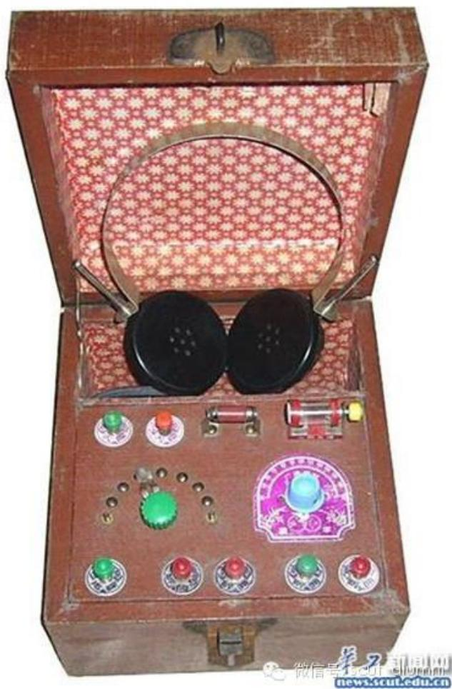
“矿石收音机”源于早期的检波器元件是直接天然矿石作成，使用时需通过一根金属探针，调整其在矿石上的压力和方位。矿石收音机是所有无线电接收设备里最简单的一种，简单的矿石收音机由一个线圈、可变电容器、检波器及耳机构成，由于只有一个调谐回路而被称为“单回路矿石收音机”。
