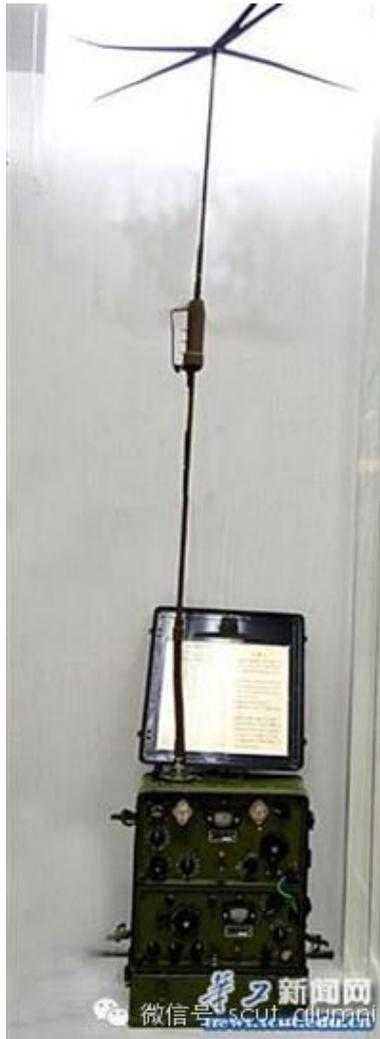
八一小型电台由“发讯部”和“收讯部”组成。连接在电台上半部的天线，是发送信号的装置。由于保密需要，军用电台与民用电台有所不同，军用电台的仪表盘上不会直接显示频率，而是显示代码，由格式刻度来表示，要内行人“解码”之后才知道频率是多少。而频率也是可调可变的，收发报双方将随时变更频率，以免信息被偷听或截获。军用电台传送信息的形式只能是声音或电码。用声音的话，需要抄录相关信息；用电码的话，要由专人译码后才知道内容。
