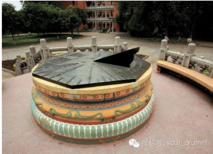
位于我校五山校区 12 号楼广场上的日晷是校园颇具特色的人文景观。日晷也称作“日规”或“日圭”，是古代利用日影测时的一种简朴装置，通常是由晷针和圆盘组成。我校日晷则属另一种投影日晷，它不设指时针，只在晷盘上置一南北径向直角三角形铜件，其斜边向上朝南，短边垂直于晷盘。铜件西、东两侧晷盘分别有若干时刻线，铜件阴影达到的时刻线表示相应的地方真太阳时。
